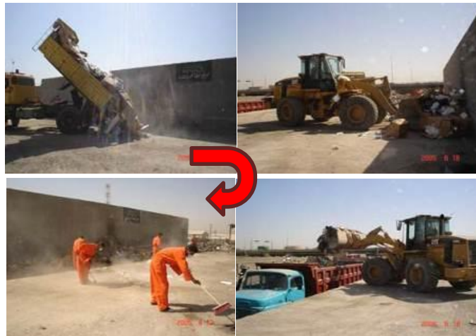
Station de transfert de base à Bagdad( Iraq) traitant 400 tonnes de déchets par jour
